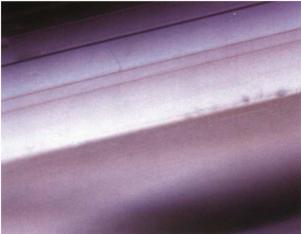
Figura 10. Quando venne osservato attraverso la faccetta dalla tavola perpendicolare alla direzione di crescita {100}, questo diamante accresciuto CVD (qui, no. 57688) mostrò venature di accrescimento parallele marroni {100}. Fotomicrofotografia di Wuyi Wang; 30x ingrandimenti.
