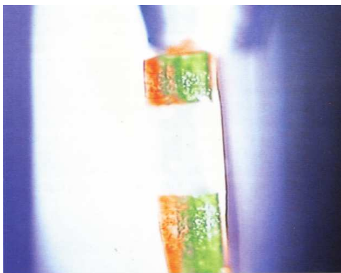
Figura 6. I due strati nell'esemplare mostrato in figura 5 evidenziano le diverse reazioni dei due materiali all'esposizione delle radiazioni UV quando questo fu osservato con il sistema del DiamondView della De Beers (diamante CVD-adulto sulla sinistra diamante accresciuto CVD con sottostrato di diamante sintetico HPHT sulla destra). Foto di Wuyi Wang.
