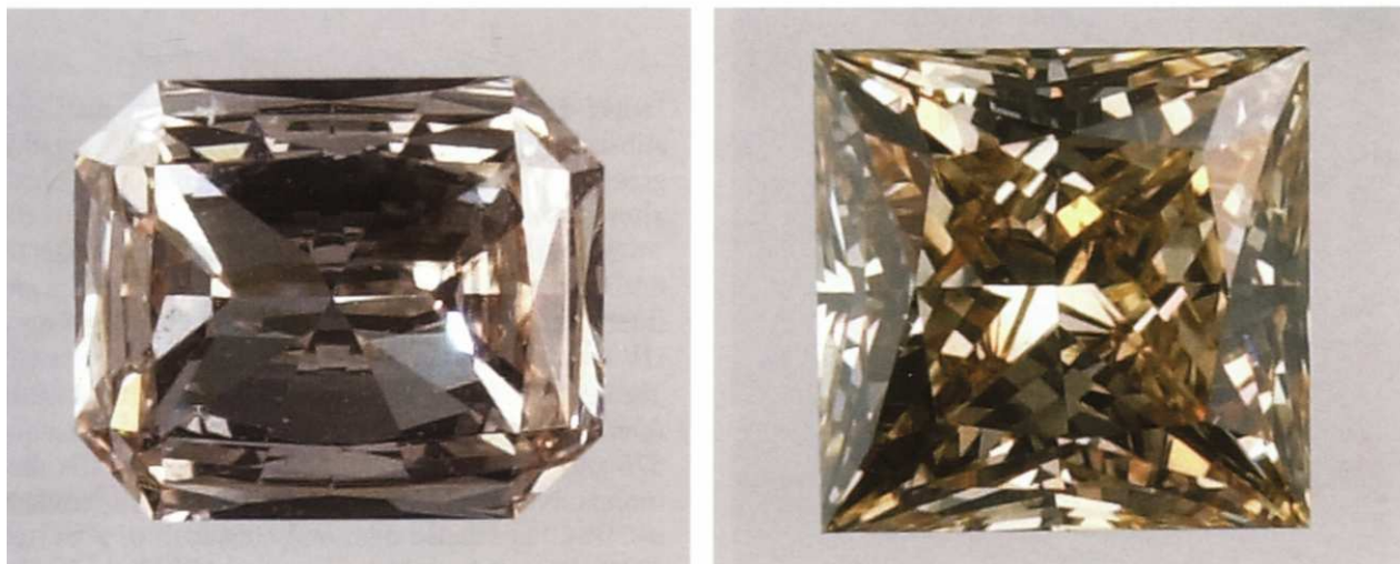
Figura 9. Come questi esemplari mostrano (sinistra, no. 4892b di 0.14ct; destra no. 49806b di 0.28 ct), i diamanti accresciuti CVD furono sfaccettati in modo da ottenere il migliore prodotto dai cristalli grezzi di forma tabulare. L'esemplare sulla destra di un colore giallo tendente al marrone è il ricavato di un cristallo vicino all'incolore (si veda tavola 1). È probabile che il cambio di colore sia avvenuto durante la fase di sfaccettatura per reazione del materiale al surriscaldamento, come avviene nei diamanti naturali. Fot di Elizabeth Schrader.
